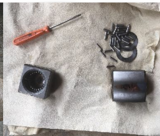
Les dés coulissants (rep. 28), leurs aiguilles (rep. 23) et rondelle (rep. 20)
